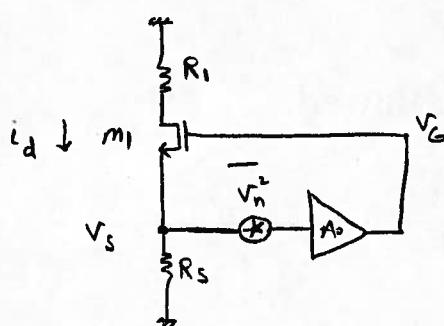
$$V_s = i_d \cdot R_S \quad V_g = (i_d R_S + V_n) A_0$$
