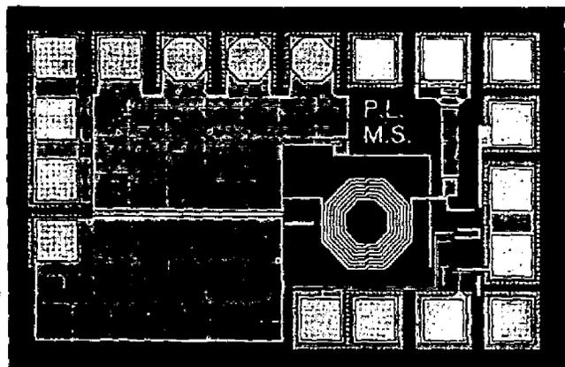
Figure 26.2.7.: LNA micrograph.
