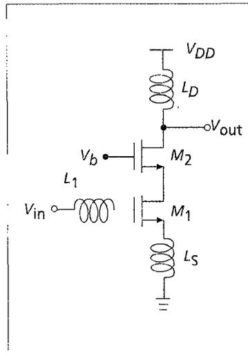
■ **Figure 9.** CMOS cascode LNA.
