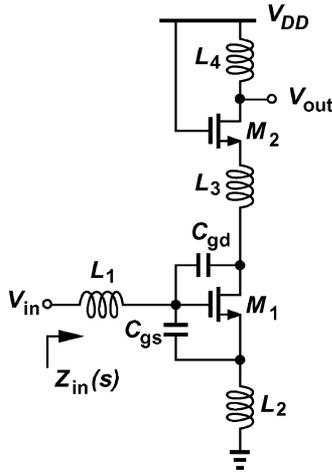
Fig. 25. Input impedance of the LNA.
