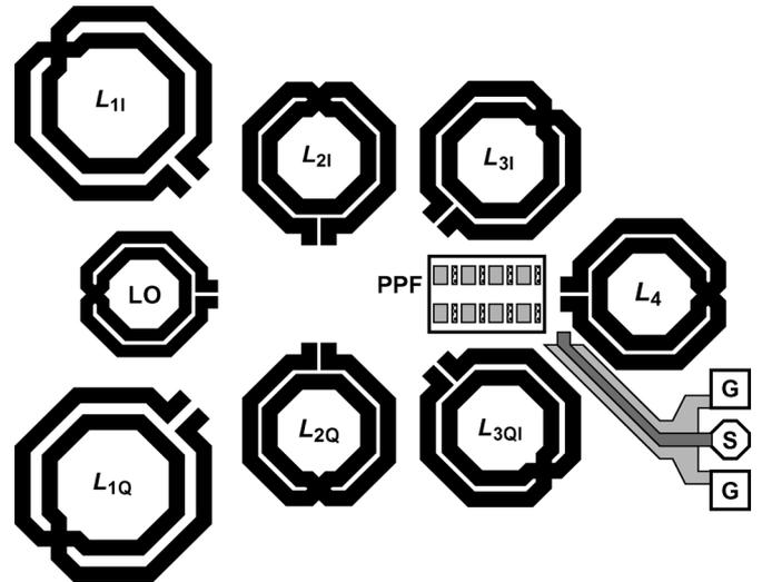
Fig. 17. Transmitter floor plan.
