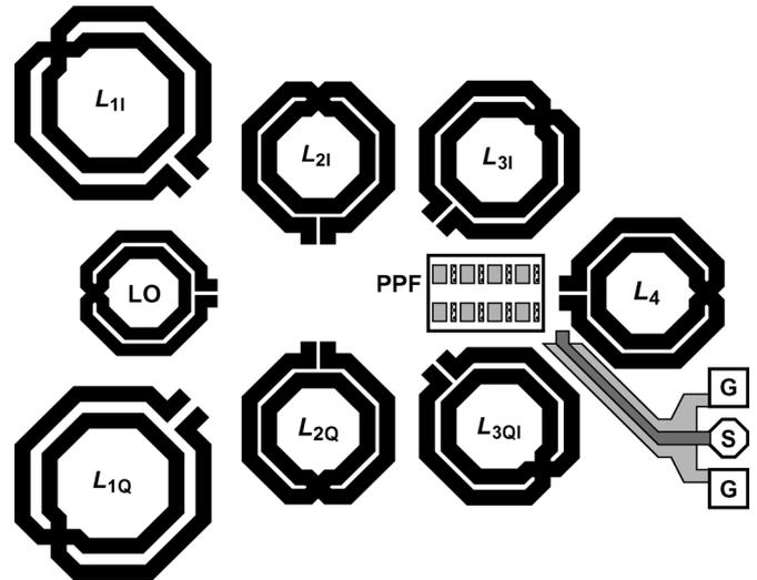
Fig. 17. Transmitter floor plan.
