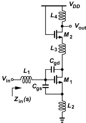
Fig. 25. Input impedance of the LNA.
